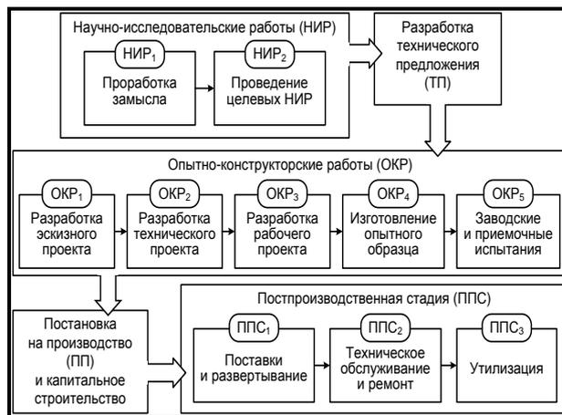
Рис. 6. Стадии жизненного цикла сложного инженерного объекта
